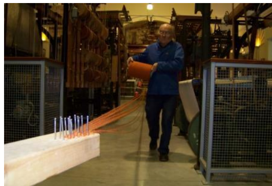
Notre « rubanier-fakir » ourdissant les fils de chaîne avec une planche à clous avant de les réunir aux pesons en pierres.
